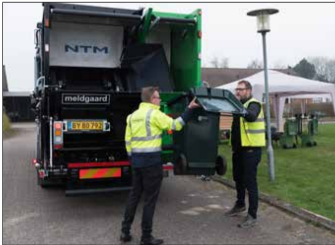
Henrik Meldgaard og Jakob Ville har trykket på tømme knappen, så affaldsbeholderen bliver tømt i den nye skraldebil. Skraldebilen har et rum til restaffald og et rum til madaffald. Skillevæggen i skraldebilen støder mod skillevæggen i affaldsbeholderen, så affaldet ryger i hvert sit rum. En gang sorteret, altid sorteret.
